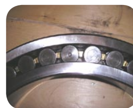
Rollen verkeerd om gemonteerd
