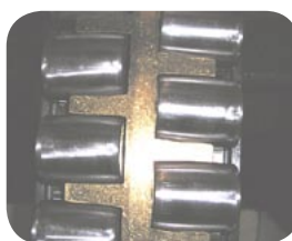
Rollen afgeslepen in plaats van buitenring uitgeslepen
